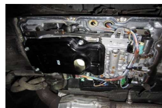
ボルト折れを修正したAT
