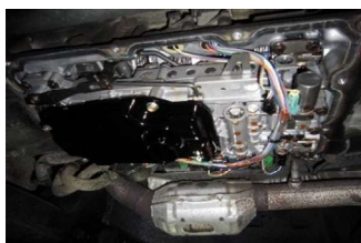
塩カリで取付けボルト折れ
