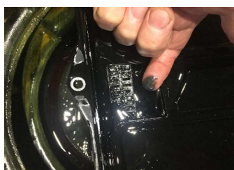
ATストレーナー付きオイルパン(右使用済) マグネットに付着した鉄粉
