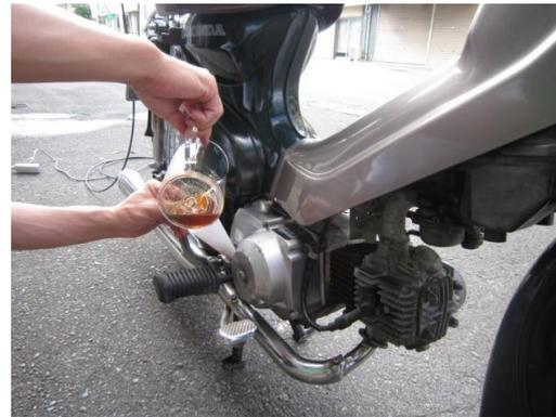
\* **SOD-1Plus 添加後約100km通常走行を行い、燃焼室の吸排気バルブ・プラグを確認**
